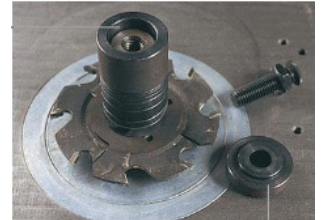
Figure 21. Montage correct des bagues
